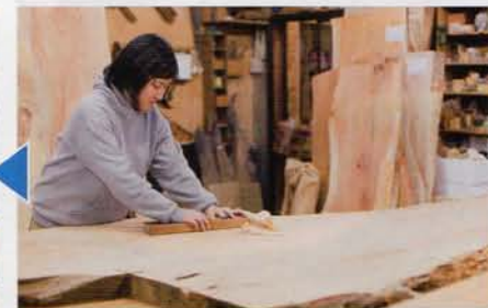
⑤鉋(かん)がけ…木取りした木板に鉋をかけ、表面全体を滑らかにする。鉋は通常より持ち手部分が長いものを使用。写真は次女里沙子さん
