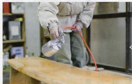
③塗装…全てのパーツをつくり終えた後、塗装する。木そのものの色味を生かすため、無色の塗料で仕上げる
